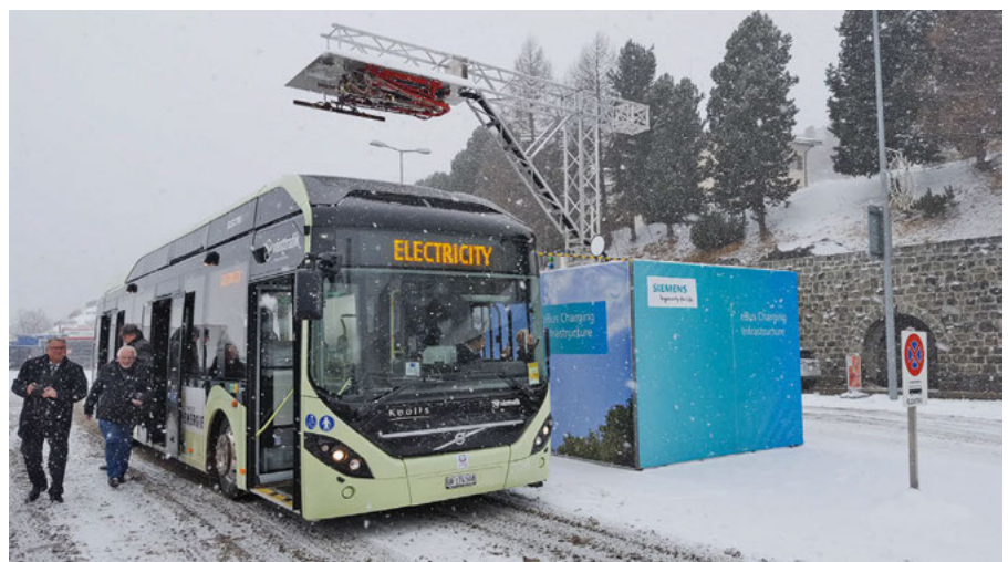
1 | Die erste mobile Schnellladestation der Schweiz im Testeinsatz in St. Moritz: Bereits nach sechs Minuten ist der Elektro-Hybrid-Bus aufgeladen.
