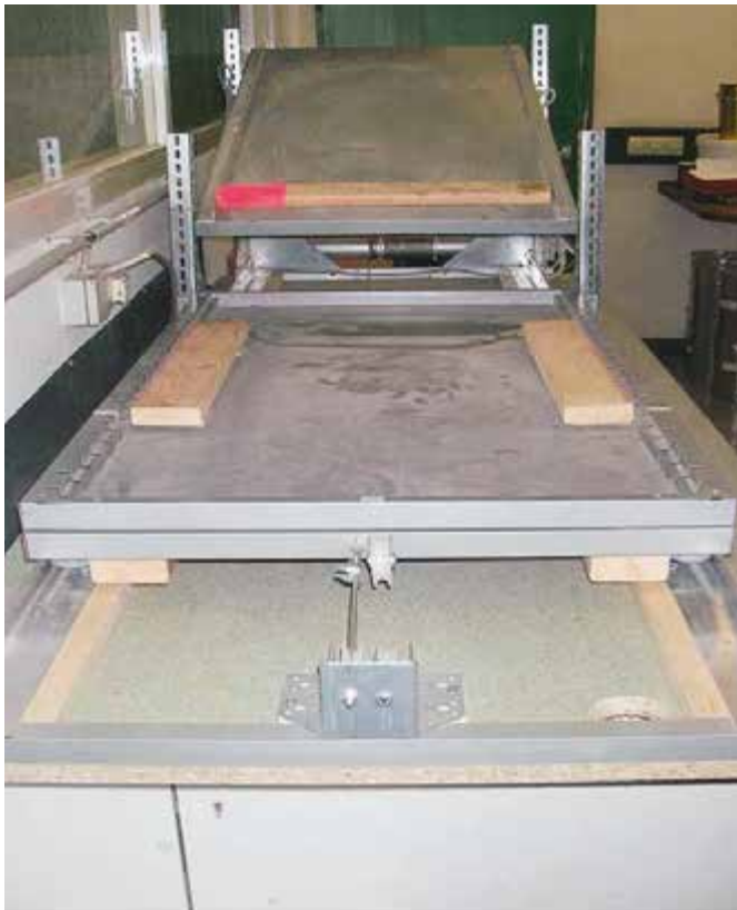
3 | Automatische Splitt-Dosiereinrichtung im Labor. 3 | Dispositif automatique de dosage de gravillons dans le laboratoire.
