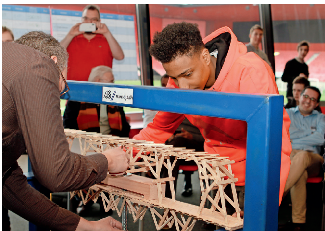
7 | Vorbereitung für den Bruchtest: Die Lehrlinge achten darauf, dass ihr Modell korrekt im Prüfstand montiert wird. 7 | Préparation du test de rupture: les apprentis veillent à ce que leur maquette soit correctement montée sur le banc d'essai.
