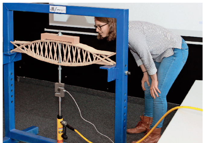
8 | Der spannende Moment: Auf dem Prüfstand wird die Modellbrücke solange belastet, bis sie bricht. 8 | Le moment palpitant: sur le banc d'essai, la maquette de pont est chargée jusqu'à ce qu'elle s'écroule.
