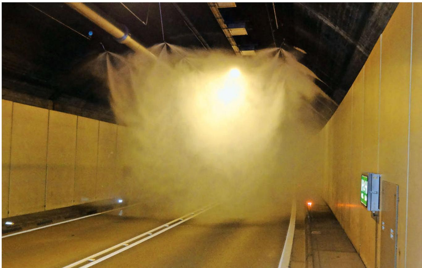
1 | Test einer Wassernebelanlage im City-Tunnel Bregenz [ohne Lüftung].
