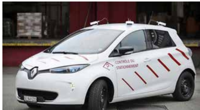
4 | «Scan Cars» erfassen automatisch Nummernschilder parkender Fahrzeuge. 4 | Le scan car (source: Fondation des Parkings).
