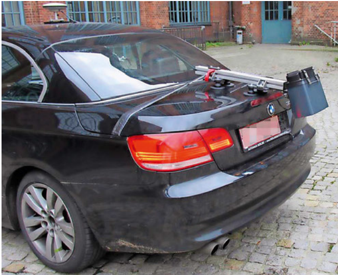
5 | Installation des MARWIS am Test-Fahrzeug der TU Berlin (© KFZB).
