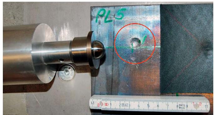
5 | Der Fallkörper nach SN EN ISO 13428 weist einen halbkugelförmigen Kopf auf. Zur Prüfung wird zwischen der unten liegenden Stahlplatte und dem oben liegenden Prüfmuster eine Bleiplatte angeordnet. Gemessen wird die Restdicke der Bleiplatte in Prozent nach dem Einschlag des Fallkörpers.
