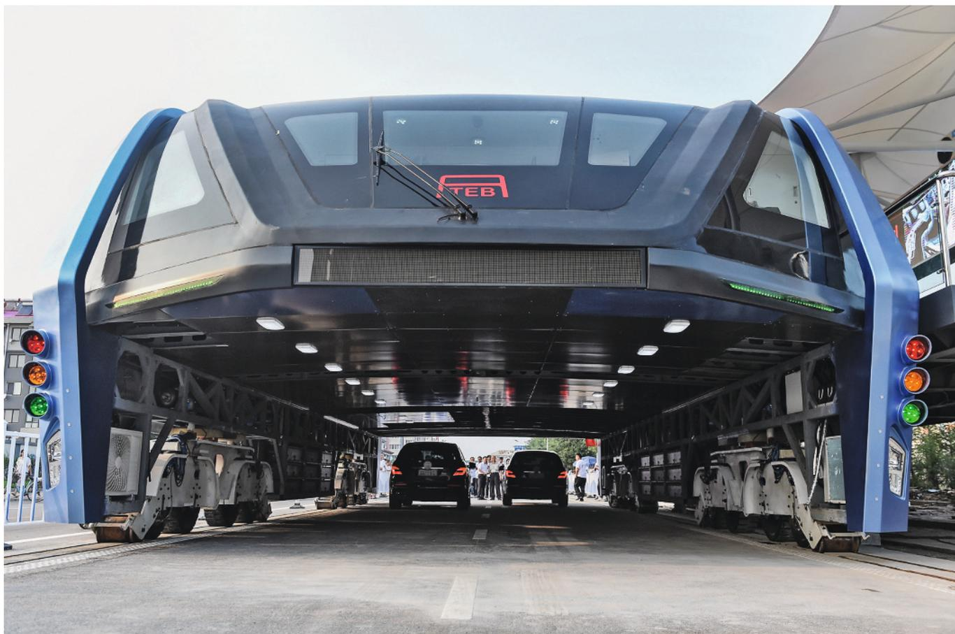
1 | Der Stelzenbus TEB aus China fährt mit bis zu 50 km/h über den Strassenverkehr hinweg und bietet oben Platz für 300 Fahrgäste.
