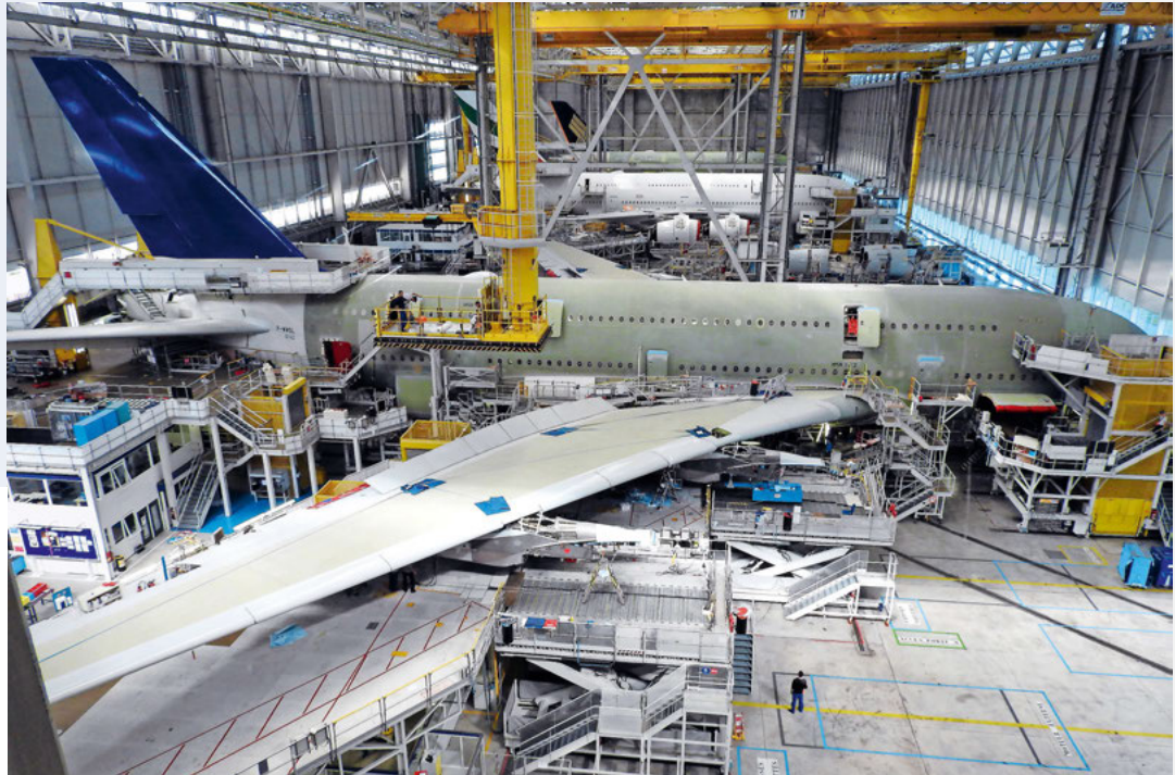
2 | Blick in die gigantischen Produktionshallen, wo die Endmontage des A380 stattfindet. 2 | Vue des gigantesques hangars de production où s'effectue le montage final de l'A380.
