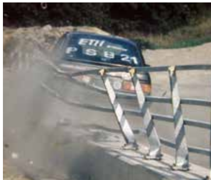
Das Lenzlinger Stahlgeländer beim Anpralltest nach EN 1317-2, TB 32: Mit einer Geschwindigkeit von 121 km/h rast das Testfahrzeug in einem Anprallwinkel von 20 Grad auf das Geländer, das nicht durchbrochen wird.
