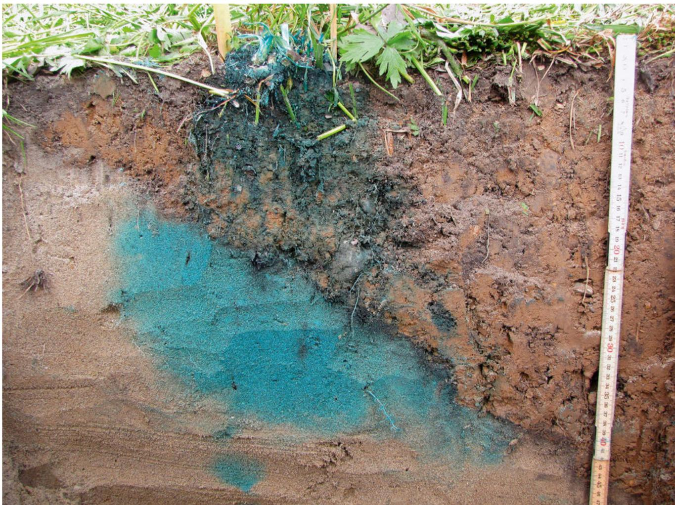
5 | Fließmusterbild am Standort Forch 6, bei dem im Bereich des Zulaufes nachträglich Sand in den bestehenden Bodenfilter eingebaut wurde. Die Abbildung zeigt die «Böschung» der Sandschicht. Der Boden wurde nach Einbringen des Sandes wieder darübergezogen, um eine gleichmässige Oberfläche zu erhalten.
