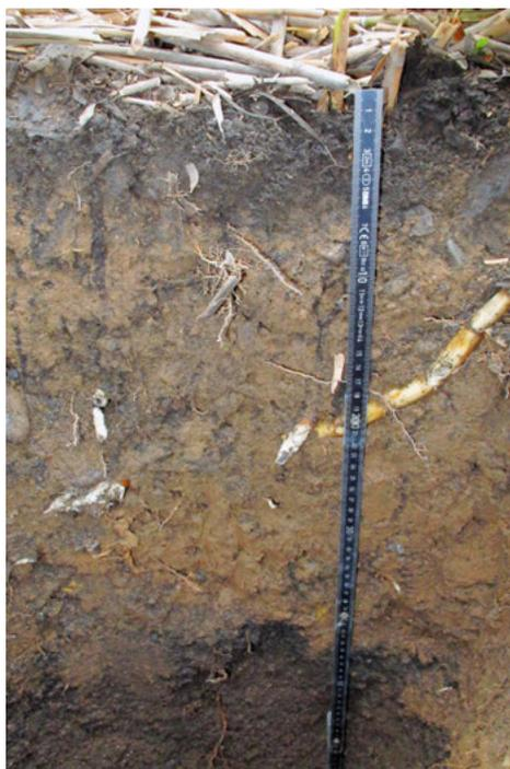
2 | Vergleich zwischen Boden- und Sandfilter. Links: oberste Schicht eines Sandfilters mit Invasionszone. Rechts: oberste Schicht eines Bodenfilters mit als dunklere Stellen erkennbaren Ablagerungen von partikulären Schadstoffen entlang präferenzierter Fließwege.
