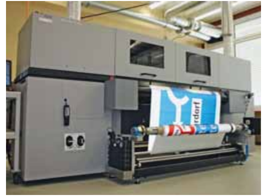
Der Durst RHO 162TS Plus produziert Verkehrsschilder.
