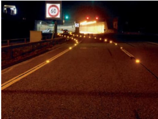
Abb. 8 Einstreifige Überleitung nachts
