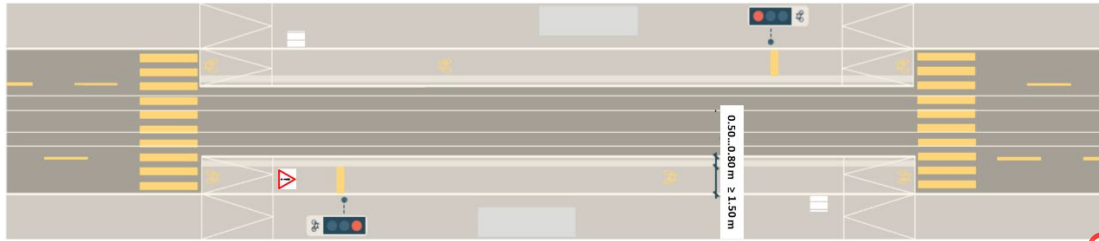
Fig. 21 Guidage des vélos sur l'arrêt (passage sur le quai)
